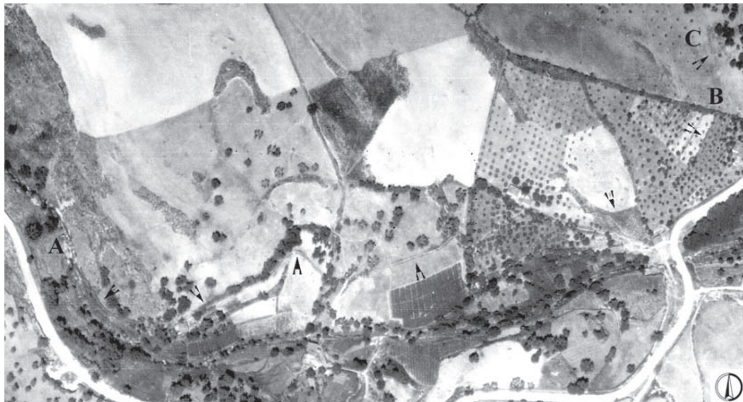
Fig. 14. Tracce nell'aerofotografia riconducibili al tracciato dell'acquedotto occidentale, dal suo punto di captazione (A) all'ingresso entro il circuito murario (B). All'interno dell'area urbana, alcune anomalie potrebbero indicare la presenza di un castellum aquae (C) (fot. 232, strisciata 9, volo 1952).
